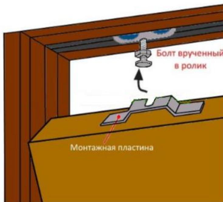
6. Отрегулируйте высоту двери, добившись равномерного зазора между полом и дверью и зафиксируйте контргайкой
